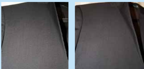
Figuur 5 en 6: Voorbeelden van de verschillende resultaten na het afwerken met de form finisher, voorafgaand aan het strijken. Na drie reinigings- en droogcycli. Sterke aanwezigheid van bubbels en kreukels aan de e rechterkant (allemaal verwijderd met strijken).
