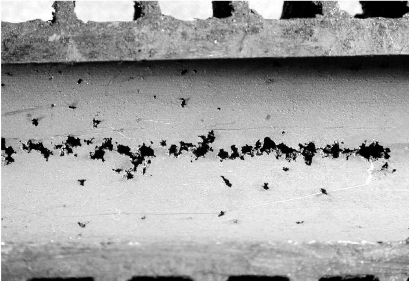
Figuur 5. Cavitatie laat een dergelijke aantasting zien. (foto: S. Vrijhoeven; Ondeo Nalco)
